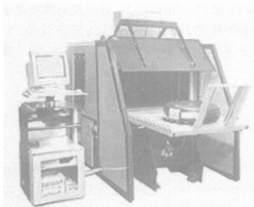
图 Shearography 检验试验机
