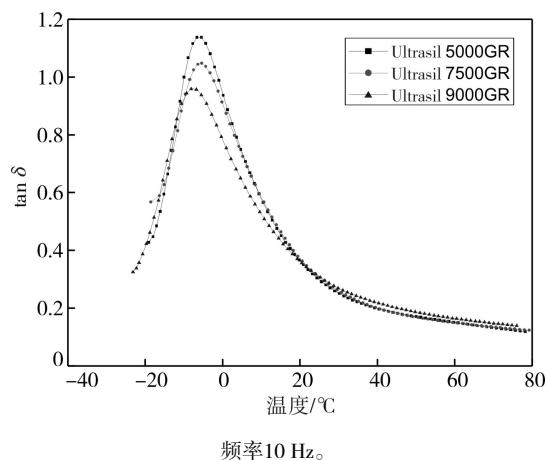
图1 3种胶料的 $\tan\delta$ 与温度的关系曲线
