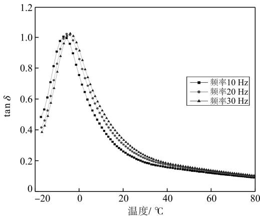
图4 白炭黑Ultrasil 5000GR胶料在不同扫描频率下tanδ与温度的关系曲线
