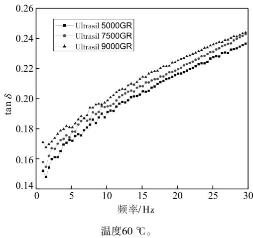
图3 3种胶料扫描频率与tanδ的关系曲线
