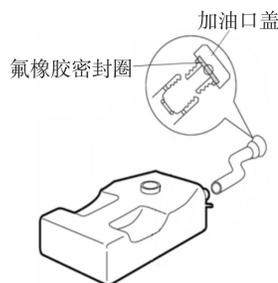
图7 加油口盖密封圈示意
