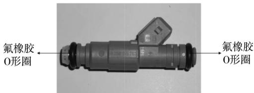
图6 喷油器O形圈
