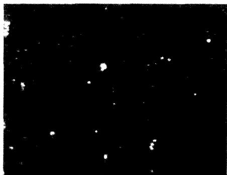
图3 未使用偶联剂白炭黑的胎冠胶(W-2# 配方)电镜照片
