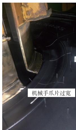
图3 硫化机机械手爪片
