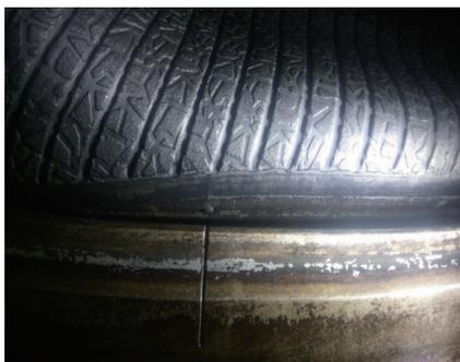
图2 胎圈圆趾缺陷
