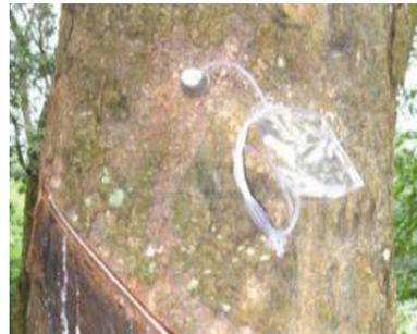
图4 HH-2型气刺装置安装效果
