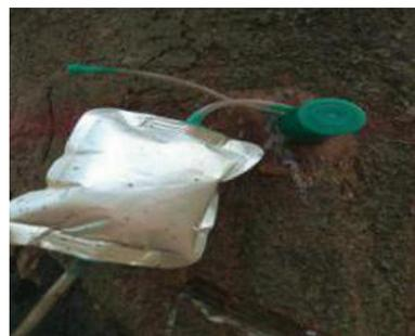
图5 直接嵌入式气刺装置安装效果
