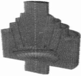
图8 轴箱弹簧的有限元网格模型
