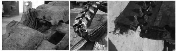
图11 橡胶履带使用不当导致的钢丝帘线断裂
