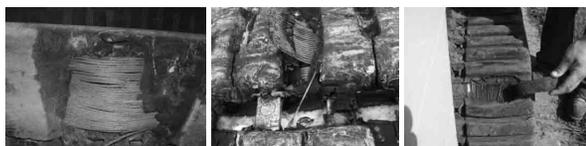
图9 橡胶履带钢丝帘线胶脱层导致的钢丝帘线断裂
