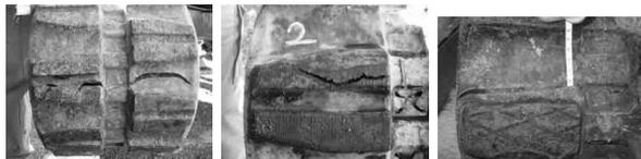
图2 橡胶履带硫化过程中接头部位花纹侧胶裂口
