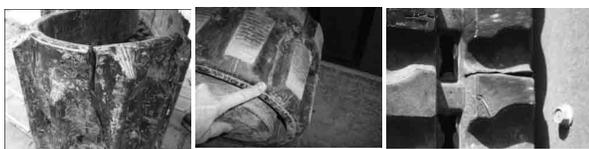
图7 橡胶履带使用过程中接头区域开裂
