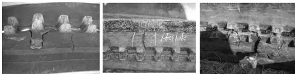
图6 橡胶履带使用过程中芯金上轮侧胶裂口
