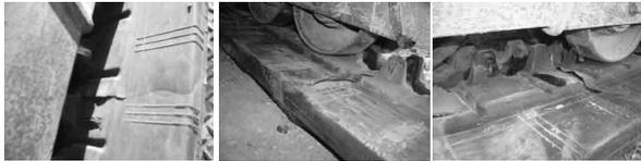
图3 橡胶履带硫化过程中轮侧胶裂口
