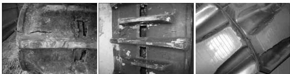
图4 橡胶履带二次硫化时内侧花纹侧胶裂口
