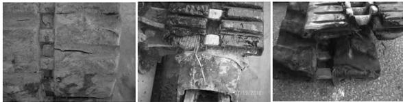
图10 橡胶履带带体裂口导致的带体钢丝帘线断裂
