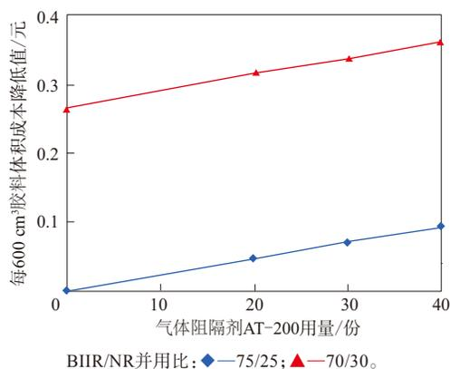
图2 气体阻隔剂AT-200对胶料体积成本的影响
