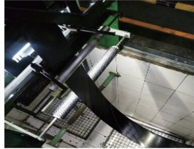
图3 小角度带束层储料坑
