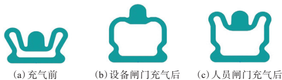
图3 空气闸门中空充气密封条充气前后的断面形状
