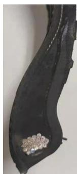
图2  $\Phi 1.2$  mm高强度胎圈钢丝生产的5-6-5-4胎圈断面
