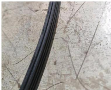
图1 Φ1.3 mm高强度胎圈钢丝生产的4-5-4钢丝圈
