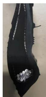
图3  $\Phi 1.3$  mm高强度胎圈钢丝生产的4-5-4胎圈断面
