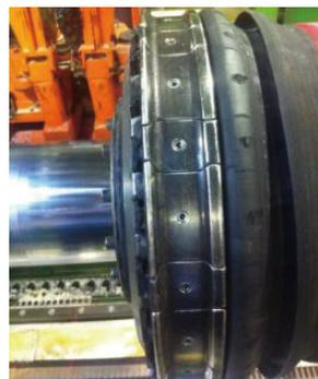
图2 成型鼓撑块与胶囊组合示意
