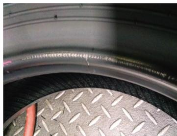
图1 胎坯胎圈内径偏大造成的成品轮胎胎圈缺胶
