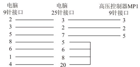
图2 高压控制器MP1的接线方式
