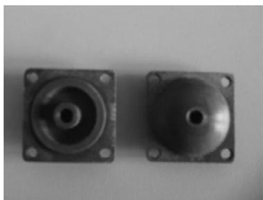
图7 硅橡胶/金属复合减震器
