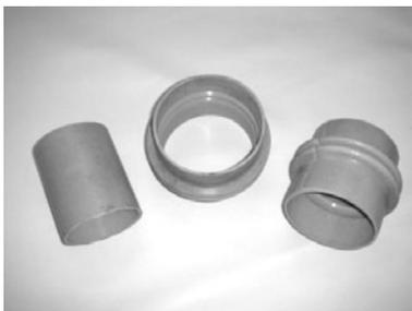
图3 硅橡胶/聚酰亚胺纤维复合波纹软管
