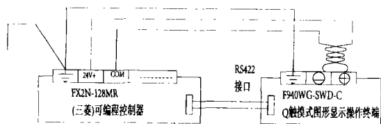
图 10 变频器控制系统示意图
