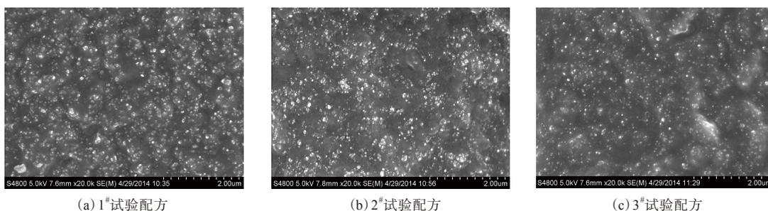
图7 各试验配方硫化胶断面的SEM照片
