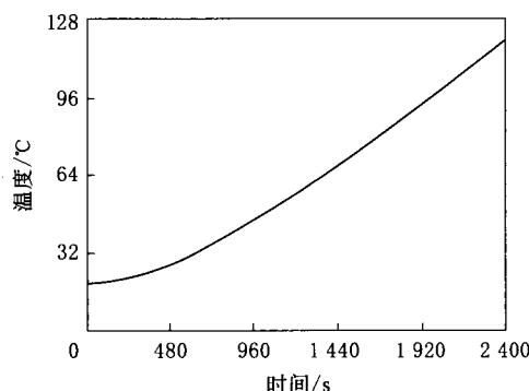
图4 蒸汽加热温度随时间变化曲线
