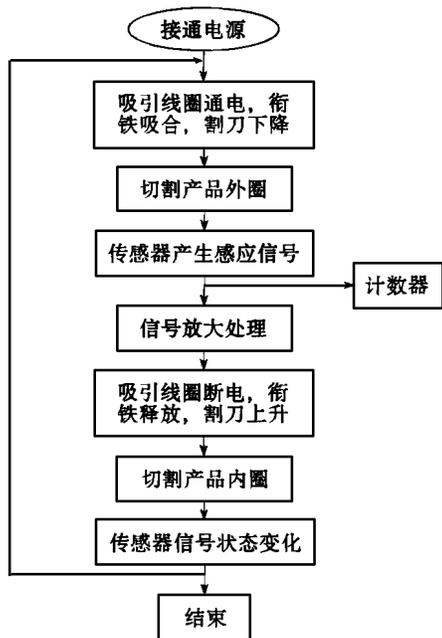
图3 割刀自动转换装置电气控制原理
