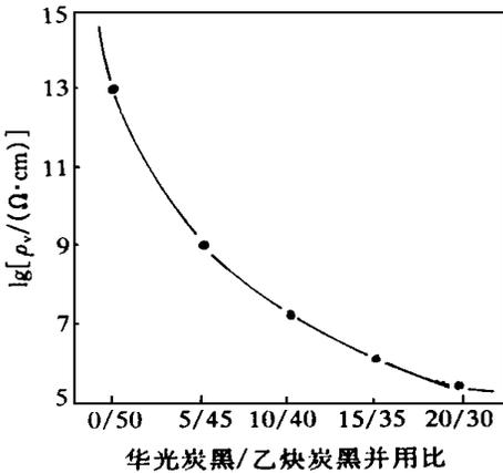
图4 华光炭黑/乙炔炭黑并用比对硫化胶体积电阻率的影响
