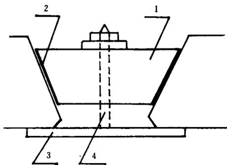
附图 铁轨枕板密封胶条横截面示意图
