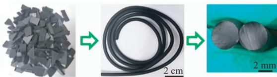
(b) 骨骼网络弹性体的挤出再加工
