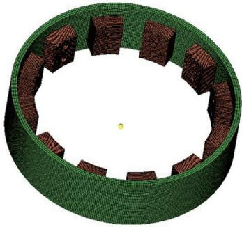
图1 产品的钢筒和12个HE的有限元网格
