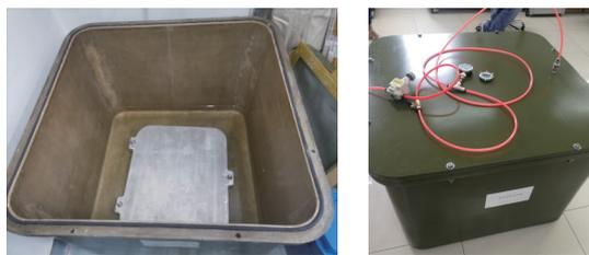
图16 浸溃水密性试验装置
