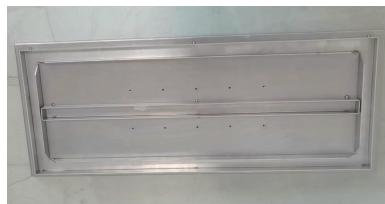
**图5 密封框的安装框架**
