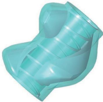
(a) 单螺旋冷却结构
