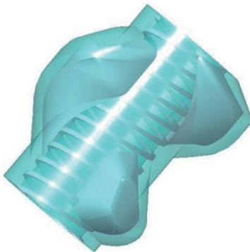
(b) 双螺旋冷却结构
