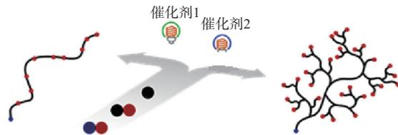
图2 有机光催化剂调控的“多样化”可控自由基聚合
