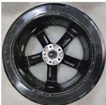
图4 浇注成型的聚氨酯轮胎外观
