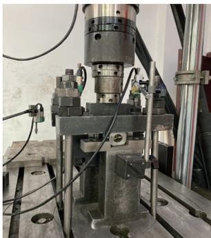
图 5 橡胶液力球铰空向静刚度试验示意
