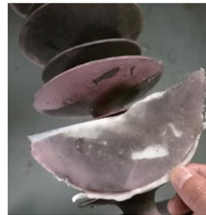
(c) 老化的复合绝缘子
