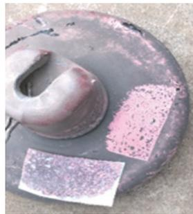
(b) 老化的RTV涂层绝缘子
