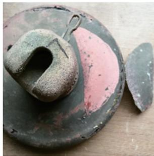
(a) 未老化的RTV涂层绝缘子
