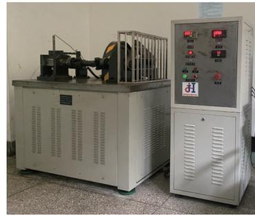
图2 挂胶履带销胶环扭转疲劳试验机
