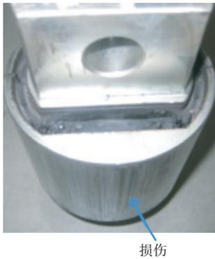
图6 整体式橡胶关节的表面损伤
