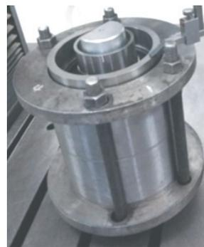
图9 轴向预压式橡胶关节使用压装工装轴向合拢
