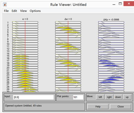
图6 Matlab软件Fuzzy工具箱 $\Delta K_p$ 的解模糊界面
