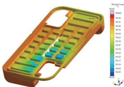
图6 螺杆挤出机热炼工艺胶料产品硫化20 min并空冷4 h后硫化程度仿真分析
