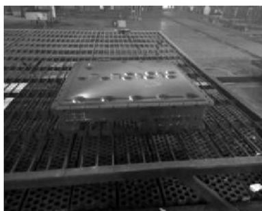
图7 电池包的火烧试验
