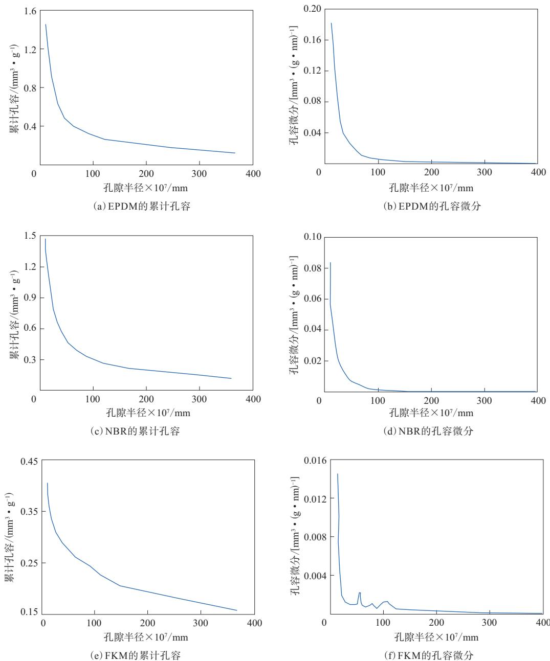
图5 3种橡胶材料颗粒的孔容
