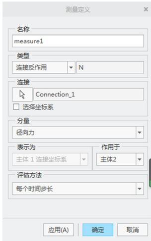
图5 胎坯径向力测量定义界面
