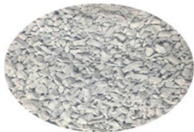
图3 工业陶瓷粉末-聚合物共混3D打印喂料的外观
