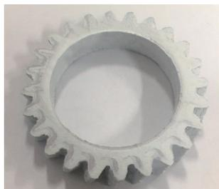
图6 优化配比工业陶瓷粉末-聚合物共混喂料的3D打印坯体
