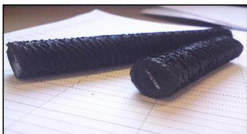
图1 挤出工艺改进前树脂硫化体系EPDM胶料的挤出胶条
