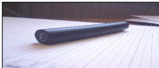
图7 采用超长机嘴和适宜工艺参数挤出的树脂硫化体系EPDM胶条
