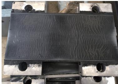
图7 疲劳试验后橡胶型摩擦阻尼器的橡胶层摩擦面形态照片
