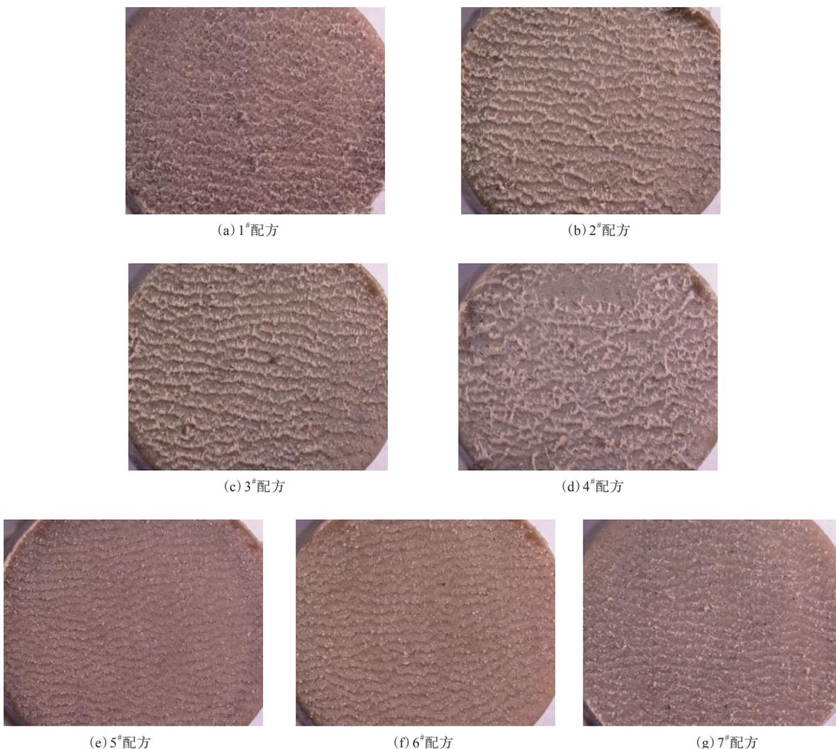
图2 NR硫化胶磨损表面的体视显微镜照片
