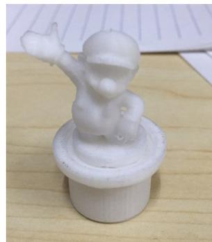
图8 采用PBSP M10聚酯打印的制品
