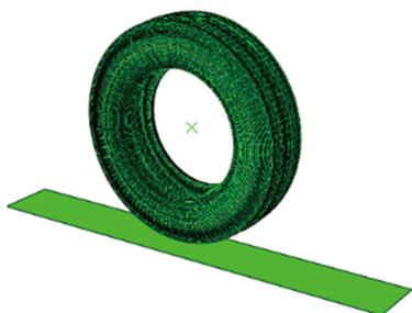
图2 轮胎三维有限元模型
