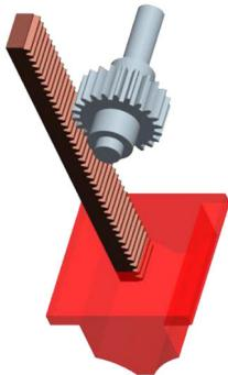
图3 压砣控制示意
