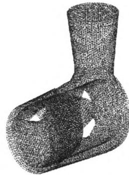
图 4 直角挤出模预成型段渠道有限元网格划分
