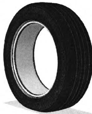
图 5 平直路面上轮胎三维有限元模型
