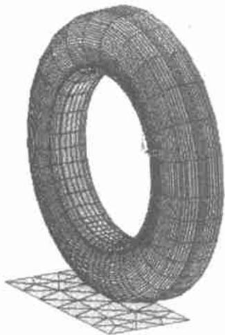
图4 205/60R15轿车轮胎接地状态下的有限元模型(半个轮胎)
