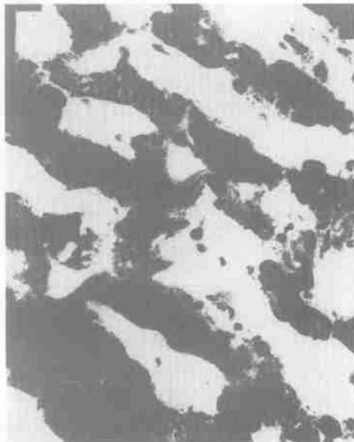
图5 乳液共沉 CR/PVC 共混物(共混比为 50/50)在 145 °C 下的形态结构(放大 5 万倍)
