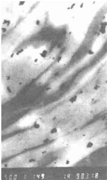
图 2 HNBR/EPDM 共混比为 40/60 的 TEM 照片
