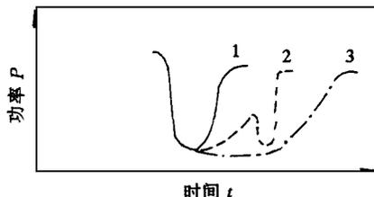
图 6 胶料与油料混炼功率曲线示意
